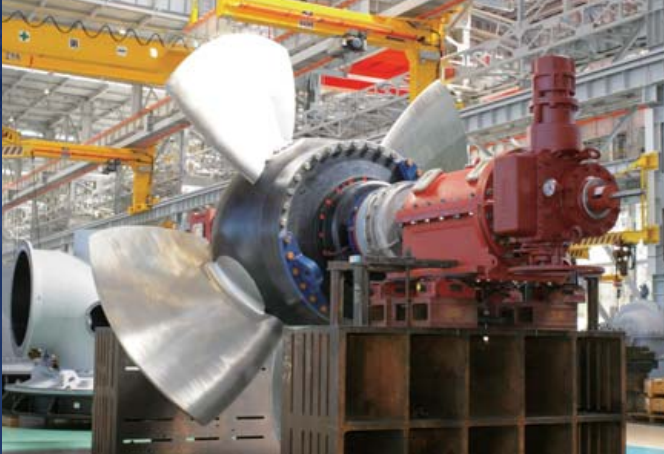
北陸農政局新川河口排水機場向けチューブラポンプ (口径4,200mm、当社最大)
