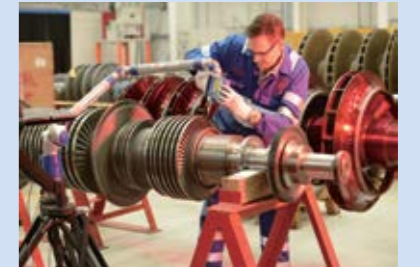
蒸気タービンの修理
