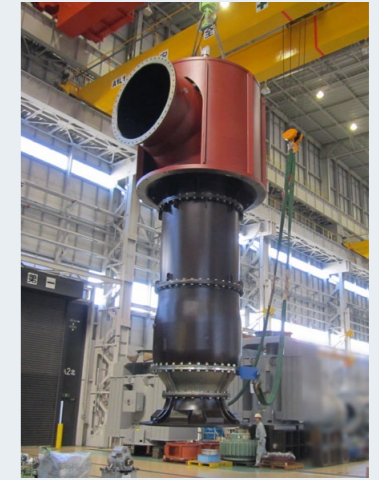
発電所向け取水用ポンプ
