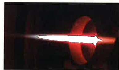
図 2. アーク型放電源の写真と膨張プラズマの様子．
