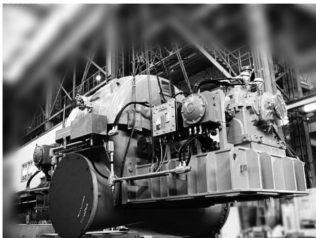
写真42 韓国向けCOGプラント用ブロウ、型式1000×800 DTBGM
