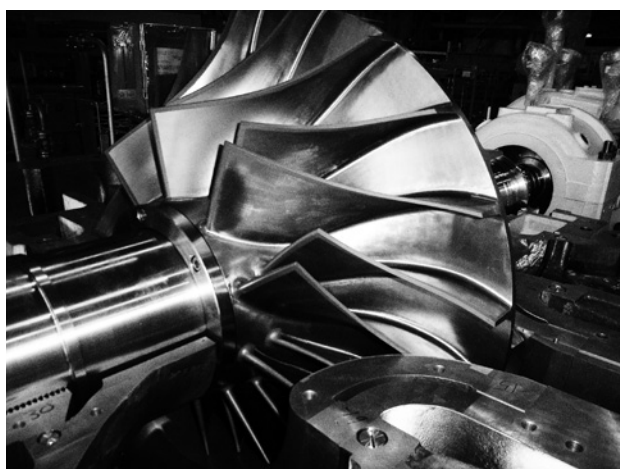
写真43 韓国向けCOGプラント用ブロウの羽根車、型式1000×800 DTBGM
