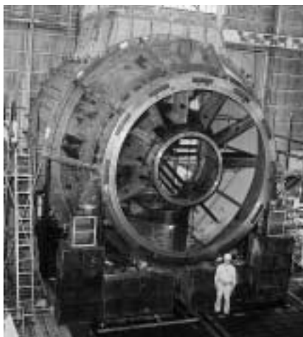
写真16 工場仮組立時の水車ケーシング Photo 16 Turbine casing assembly in shop
