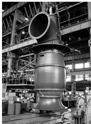
写真1 常時用ポンプ（工場試験前） Photo 1 Drainage pump for normal operation (Before testing at plant)
