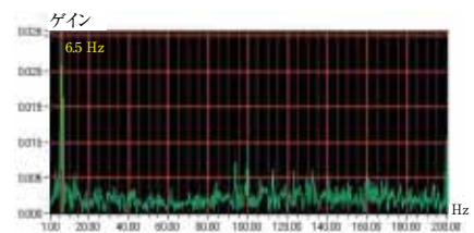
(c) キャビテーションサージの周波数成分 (吸込圧力変動成分) Frequency components of cavitation surge
