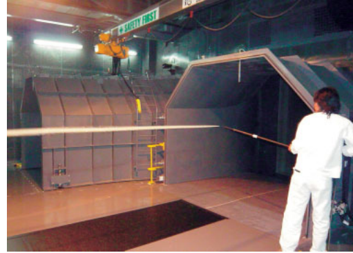
写真3 ノズル出口の気流状況 Photo 3 Wind condition at nozzle outlet
