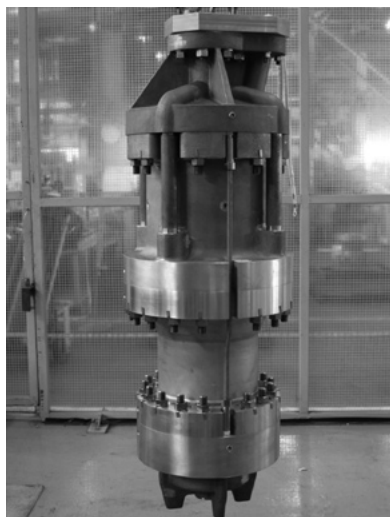
写真17 小型高速LNGサブマージドモータポンプ Photo 17 Compact high speed LNG submerged motor driven pump
