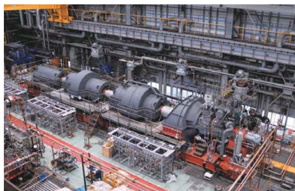
写真1 遠心圧縮機の工場連結機能試験
