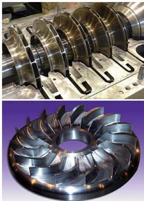
写真2 機械加工で製造されたダイヤフラム (上) と削り出し戻り流路 (下)
