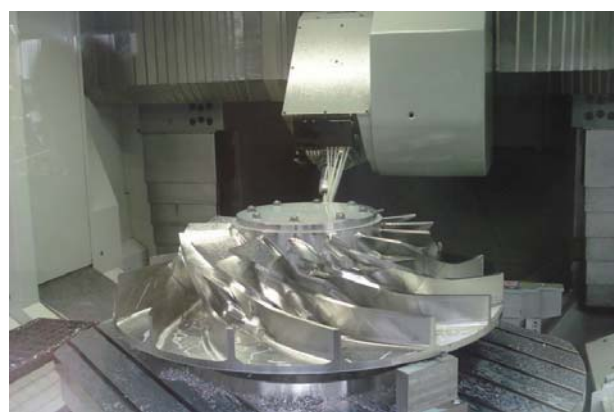
写真3 羽根車の5軸加工の様子 Photo 3 Five-axis machining of an impeller
