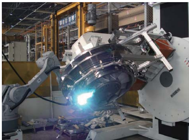
写真4 羽根車のロボット溶接 Photo 4 Robot welding of an impeller
