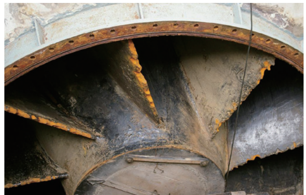
写真2 主ポンプガイドケーシング腐食状況 Photo 2 Pump diffuser casing damaged by corrosion
