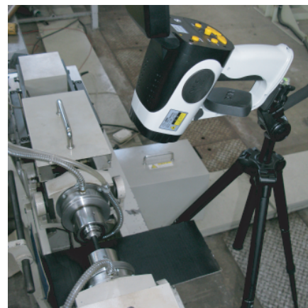
サーモグラフィ測定 (b) Measurement with the thermography
