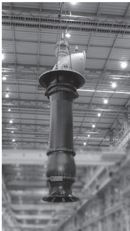
写真8 1200 mm 立軸斜流ポンプ Photo 8 1200 mm vertical mixed flow pump
