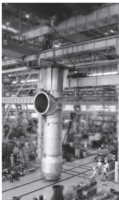
写真16 2200 mm立軸二相ステンレス鋼製缶ポンプ
