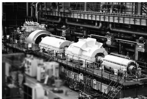
写真42 インド向け 遠心多段圧縮機（型式78MD3-3 + 78M6I + 46M9）連結機能試験
