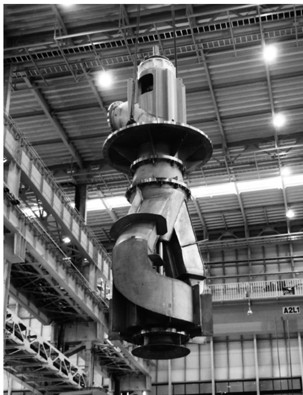
写真13 吸込口径1500 mm 吐出し口径900 mm 両吸込立軸二相ステンレス鋼製渦巻ポンプ
