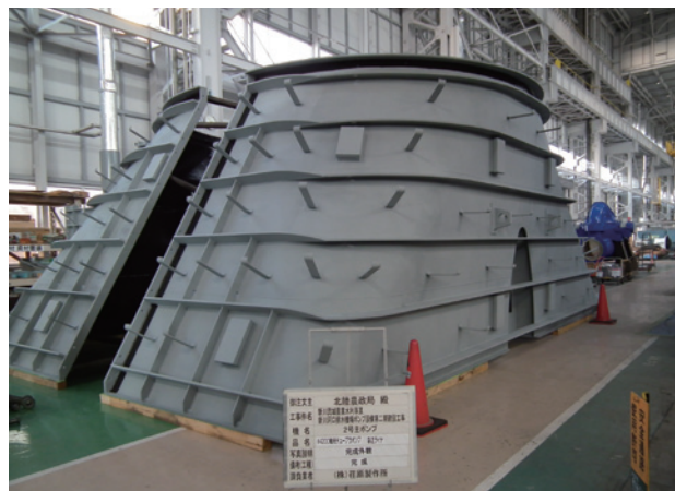
写真6 吸込ライナ（リブの配置） Photo 6 Suction liner (rib layout)
